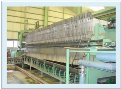
④濾過 (フィルタープレス 全長15m)
